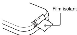
Une pile au lithium CR2025 est montée en usine dans le support.
