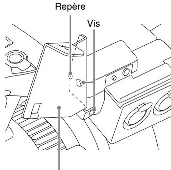
Support de fixation de l'adaptateur Wi-Fi
